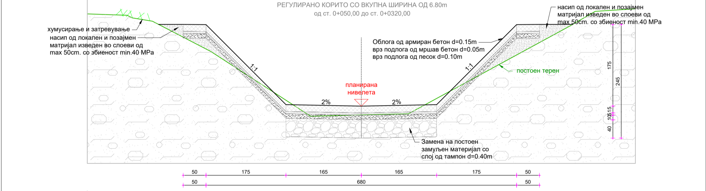
КАРАКТЕРИСТИЧНИ ПОПРЕЧНИ ПРЕСЕЦИ (ПРОФИЛИ) 1-1, 2-2 НА ДЕЛ ОД ОТВОРЕН КАНАЛ РАУЉ M=1:100
