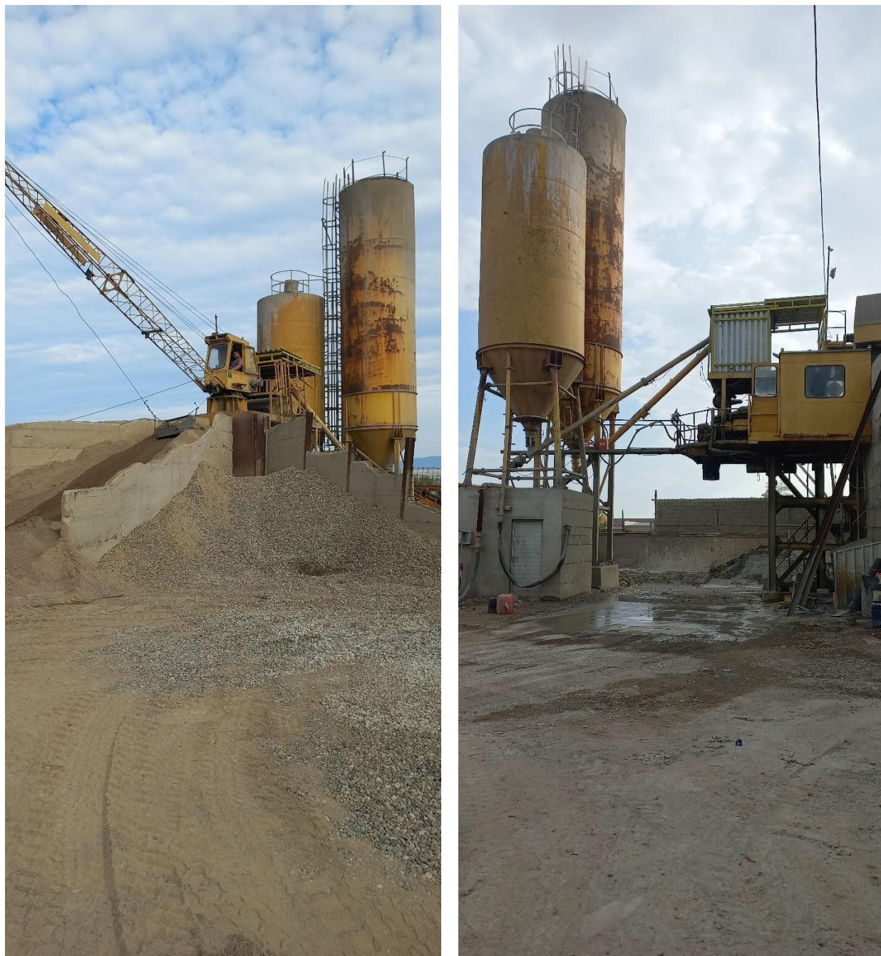
Слика 5 - 6. Приказ на бетонска база со сепариран агрегат и делови од базата
